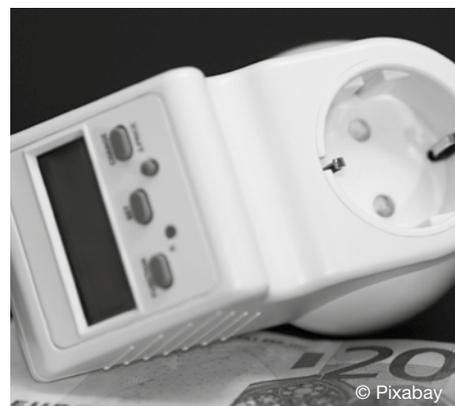
Mit Energiemessgeräten lassen sich Stromfresser ausfindig machen
